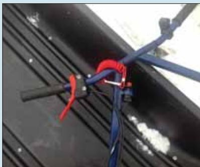
В конце третьей рыбалки, примерно после 75 км пробега отломались пресловутые «ушки-квадратики» и одновременно две пары катков вышли из строя. Пришлось идти на берег и выезжать на неокрепший лед на микроавтобусе.
