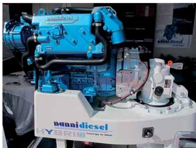
Гибридный привод с электромотором-генератором на валу между дизелем и редуктором
