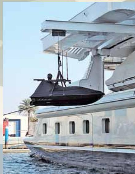
Испытание на прочность – корпус беспилотника сбрасывают на воду
