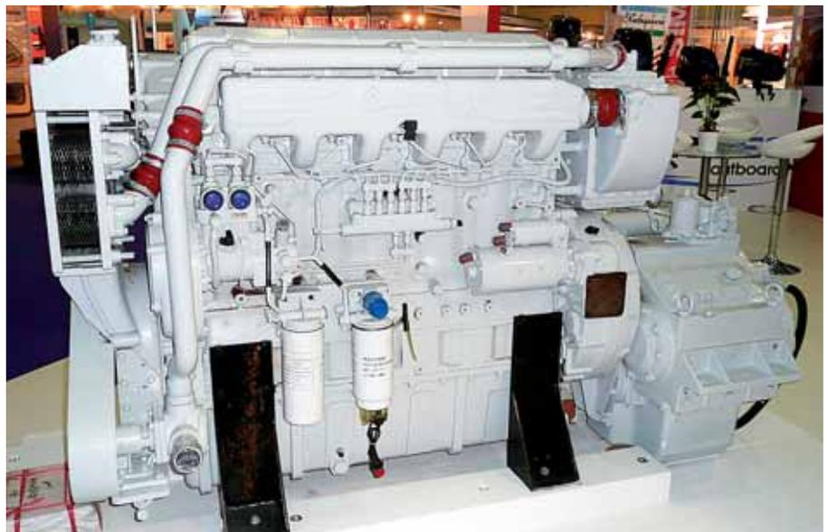
цилиндры смесь предварительно подогревается электричеством для улучшения запуска в холодных условиях. Теплообменник мотора интегрирован с коллектором выхлопных газов, что создает более компактный профиль и делает работу мотора намного тише ([www.kipor.com](http://www.kipor.com)).
