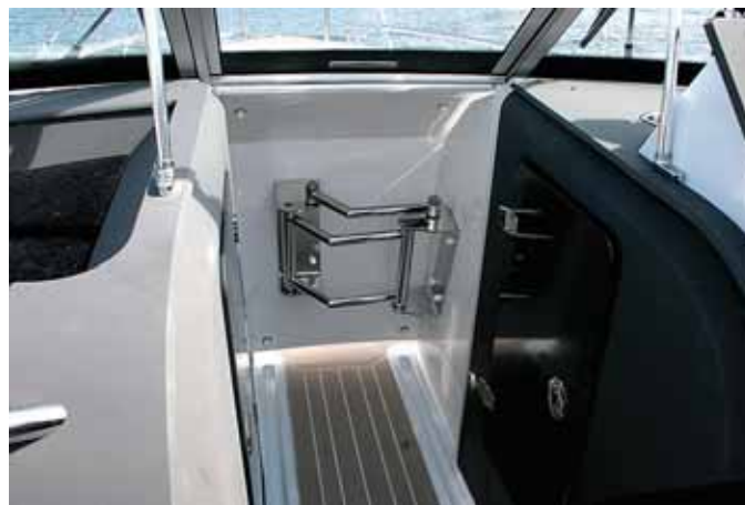
Эксклюзивность проявляется и в деталях. Необычно изогнутая газовая пружина доводчика и параллелограммный механизм подвески дверцы
