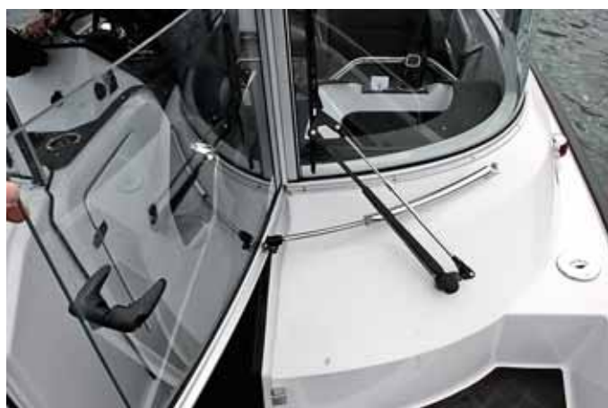
Эксклюзивность проявляется и в деталях. Необычно изогнутая газовая пружина доводчика и параллелограммный механизм подвески дверцы
