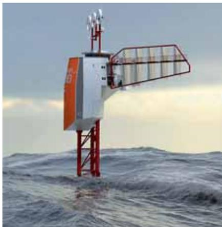
нако в отличие от прототипа, имеющего сплошной корпус, Polar Pod соединен с балластом решетчатым стержнем, еще более устойчивым на волнах.
