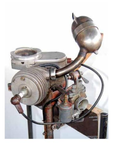
вечающая всем поставленным задачам. Мотор получился легкий и компактный, что немаловажно для туриста. Его вес порядка 9 килограммов. Также хорошим решением было использовать доступный велодвигатель с минимальными переделками. Этот самодельный лодочный мотор и сейчас работает достаточно бодро, несмотря на свой пятидесятилетний возраст!
