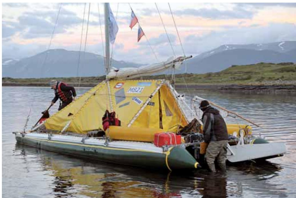
прочность и простота конструкции, а также максимальная ремонтпригодность в походе силами экипажа. Еще одна особенность «ТМС» – большая (размером 2×4 м) и высокая (в коньке 1,3 м) рубка, которая позволяет команде ночевать в катамаране на береговых стоянках, а также упрощает отдых подвахты. Катамаран разбирается на отдельные небольшие модули, что упрощает его перевозку. Сборка и сна-
