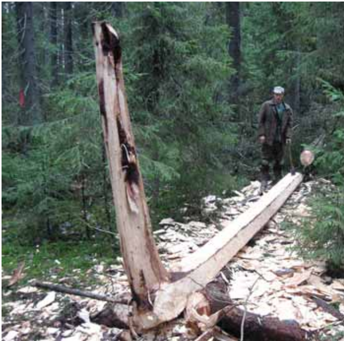
Для сравнения – заготовка корки на аналогичную курицу для постройки реплики. Деталь начерно (с запасом) вытесывается на месте, в лесу. Октябрь 2012
