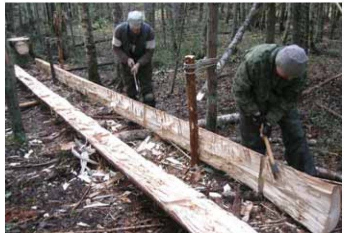
Изготовление набоев при реконструкции – бревно (ель), расколото пополам клиньями и обтесывается. Октябрь 2012
