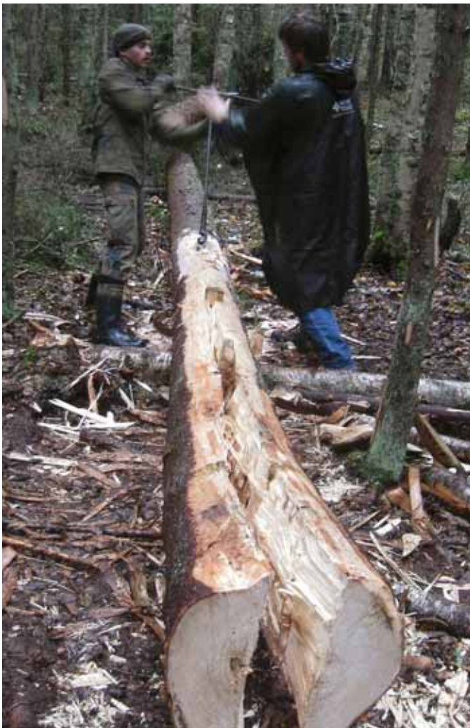
Раскалывание бревна (ель) клиньями. Сверлится отверстие по линии раскола. Октябрь 2012
