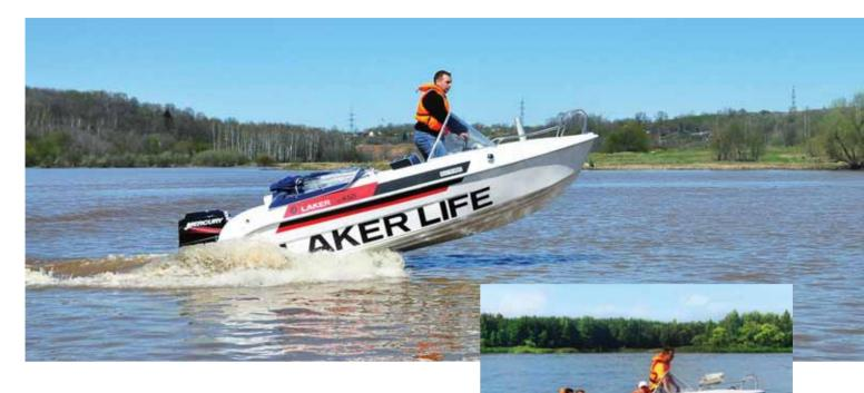
стью стеклопластиковая. Корпус выполнен с переменным углом килеватости. Он имеет довольно острый форштевень, затем на миделе угол килеватости составляет примерно 30°, и к корме он уменьшается до 15°. От форштевня до кормы расположены два продольных редана, которые к корме постепенно развиваются в горизонтальные площадки, составляющие 1/3 ширины днища.
