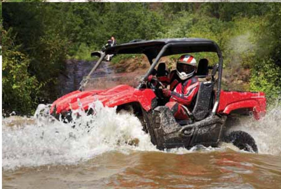
рожник самого широкого спектра возможного применения – 4-тактный, 4-клапанный одноцилиндровый двигатель (объем 686 см<sup>3</sup>) был создан на базе SOHC сердца от квадроцикла Grizzly 700. В моторе у Viking стоят новые кованые поршни, изменена камера сгорания (степень сжатия 10.01:1), улучшены кулачки распределителя, редизайну подверглась и выхлопная труба.
