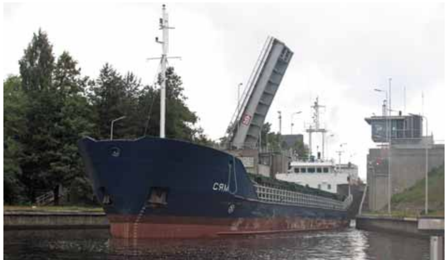
Типичный сайменский сухогруз имеет размерения 82×12.2 м и размещается в шлюзе впрытик
