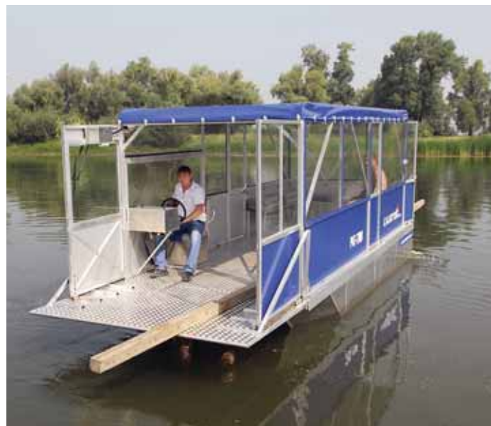
Закатить по наклонной аппарели легкий трактор – не вопрос. «Салют» охотно доставит и длинномерный груз. На воде нет ограничений по габаритам
