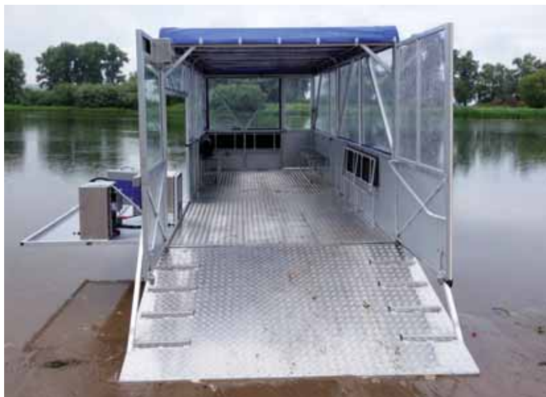
Закатить по наклонной аппарели легкий трактор – не вопрос. «Салют» охотно доставит и длинномерный груз. На воде нет ограничений по габаритам
