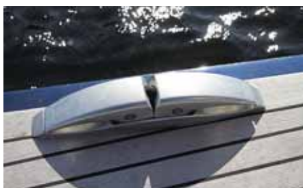
Сложенная «по-походному» утка не цепляет заводимые тросы и концы. Мелочь, но полезно
