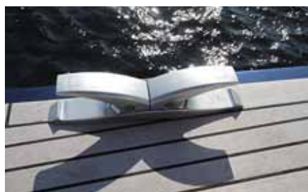
Сложенная «по-походному» утка не цепляет заводимые тросы и концы. Мелочь, но полезно
