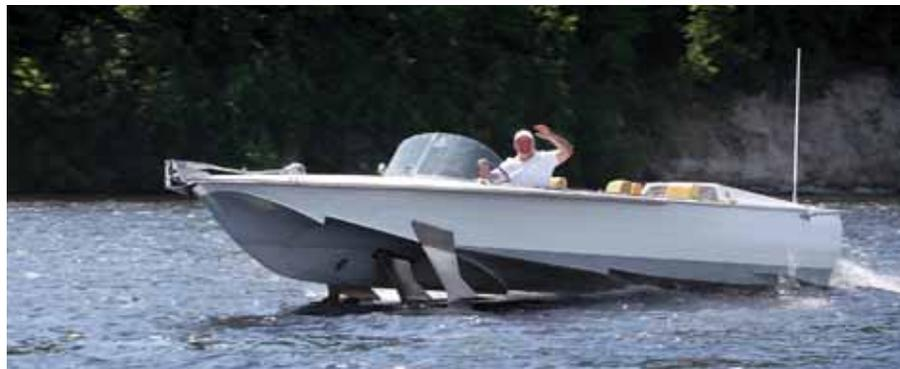
Длина наибольшая – 8.5 м, ширина – 1.95 м, водоизмещение полное – 1245 кг, мощность двигателя – 80 л.с., материал корпуса – АМГ5
