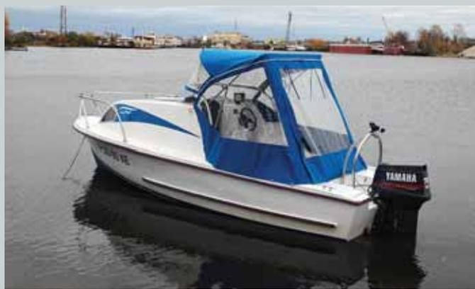
Длина наибольшая – 5,5 м, ширина – 1,9 м, запас топлива – 140 л, мощность двигателя – 70 л.с., материал корпуса – стеклопластик/фанера
