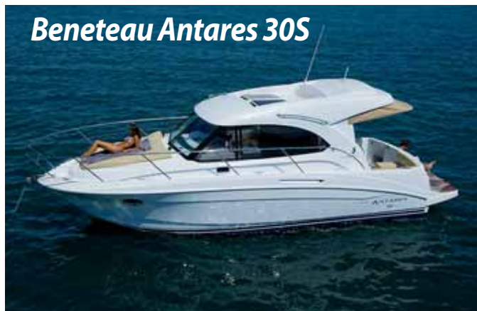
Длина – 10.22 м, ширина – 3.35 м, водоизмещение порожнем – 4550 кг, макс. скорость – 27 уз
