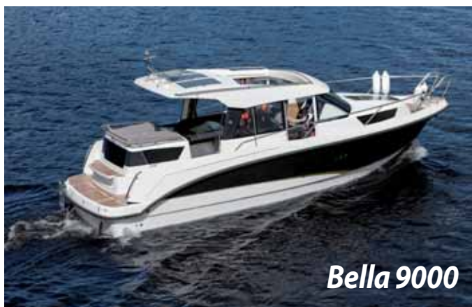
Bella 9000 Длина – 9.12 м, ширина – 3.3 м, водоизмещение порожнем – 4000 кг, макс. скорость – 15 уз
