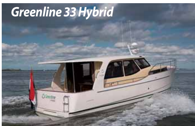
Длина – 9.99 м, ширина – 3.49 м, водоизмещение порожнем – 4800 кг, макс. скорость – 15 уз
