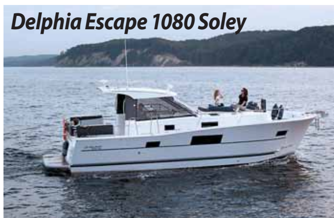
Длина – 10.8 м, ширина – 3.45 м, водоизмещение порожнем – 5300 кг, макс. скорость – 15 уз
