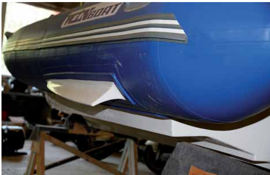
Из стеклопластика изготавливается не только корпус, но и накладные детали баллонов, наподобие этого брызгоотбойника
