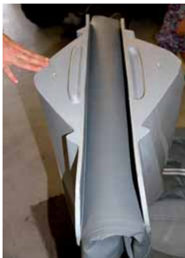
Переборки между секциями не требуют никаких уплотнительных прокладок – водонепроницаемость обеспечена гибкими соединительными звеньями из ПВХ
