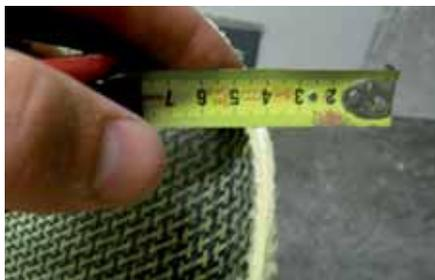
Проверка толщины ламината на критичном для прочности лодки месте: стыке деки и днища в районе носа
