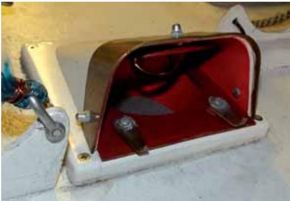
Рис.3. Самодельный вентиляционный лючок
