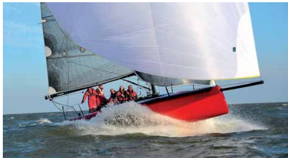
Основные данные яхты FarEast 33: длина наибольшая – 9.50 м, ширина – 2.95 м, осадка макс. – 2.1 м, водоизмещение – 1 800 кг, площадь парусности: грот/стаксель/генакер – 41/24/120 м 2
