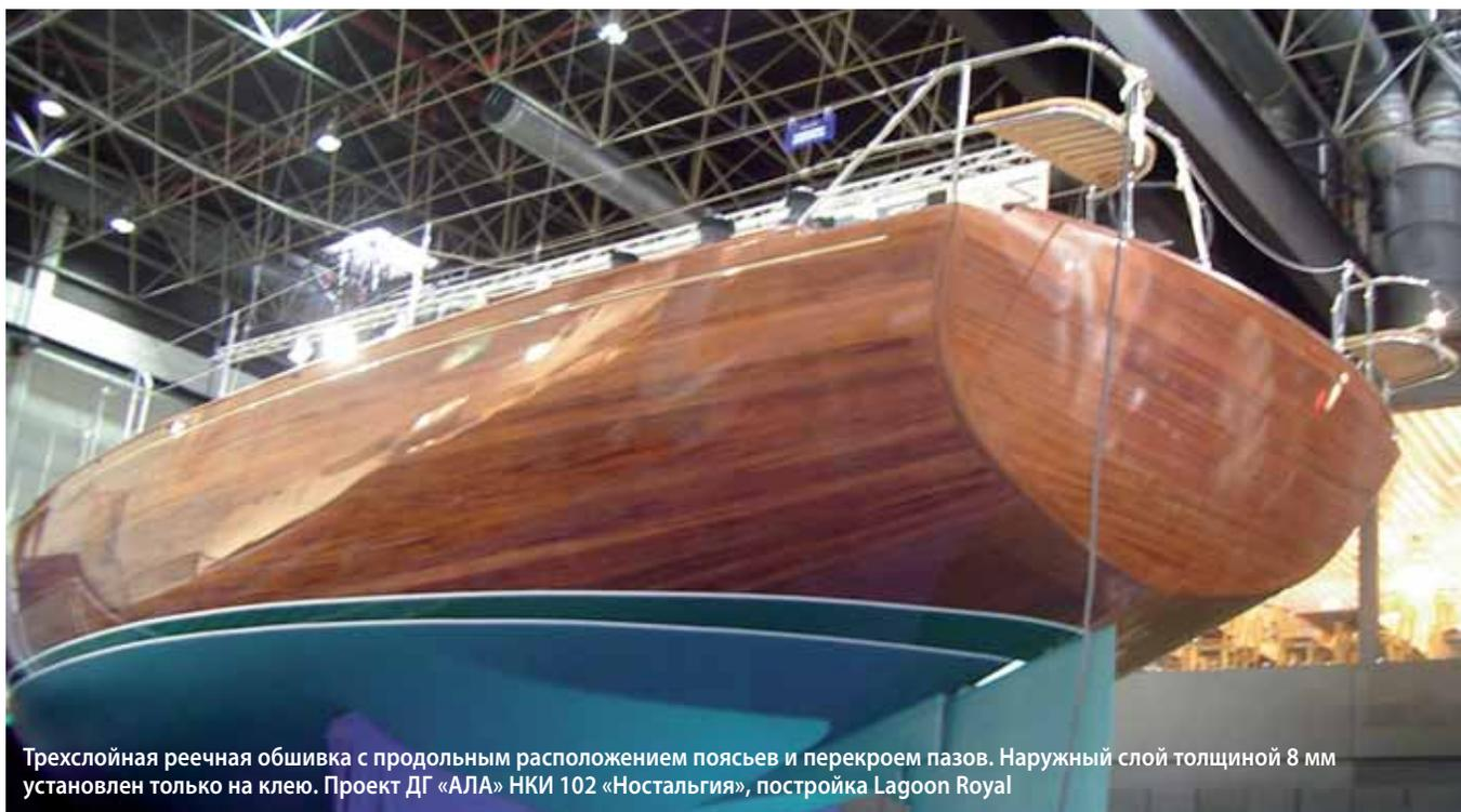
Трехслойная реечная обшивка с продольным расположением поясьев и перекроем пазов. Наружный слой толщиной 8 мм установлен только на клею. Проект ДГ «АЛА» НКИ 102 «Ностальгия», постройка Lagoon Royal
