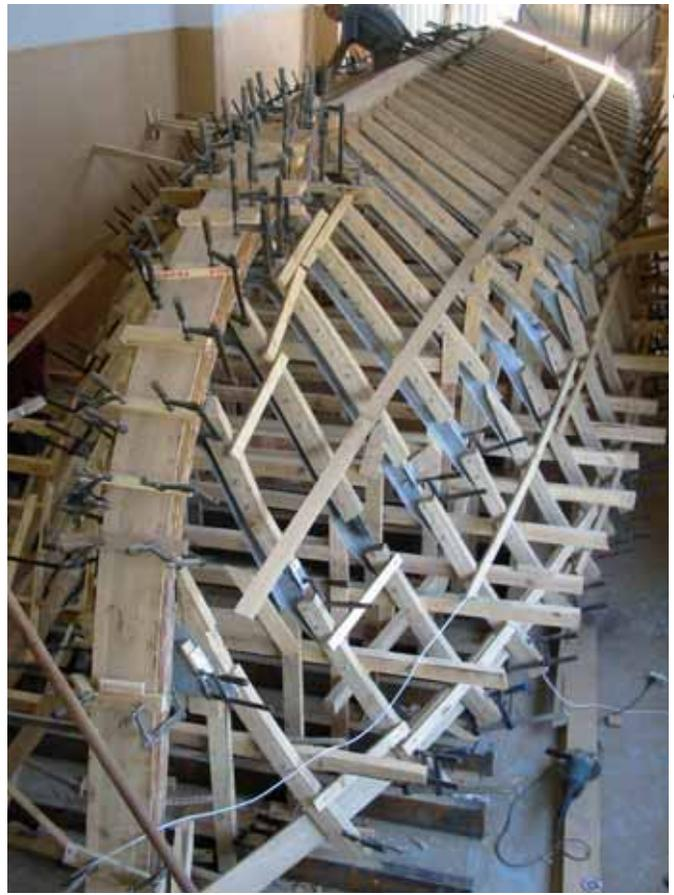
Ламинирование элементов закладки на шпангоутных рамах. Проект ДГ «АЛА» НКИ 103 «Лагуна», постройка Lagoon Royal
