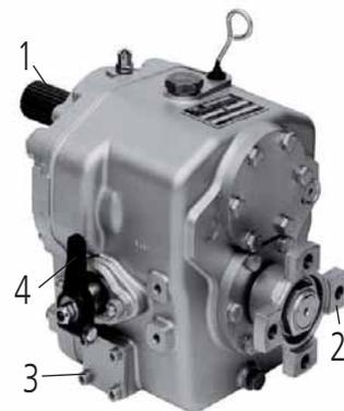
Рис. 1. Реверс-редуктор ТМС 260. 1 – входной вал со шлицами, 2 – фланец выходного вала (стандарт 4”), 3 – фланец – заглушка канала, установленный вместо водяного холодильника в виде трубы, 4 – рычаг переключения ходов
