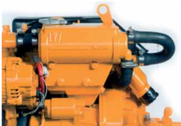
Рис. 2. Водо-водяной холодильник, охлаждаемый выпускной коллектор и расширительный бачок в едином узле
