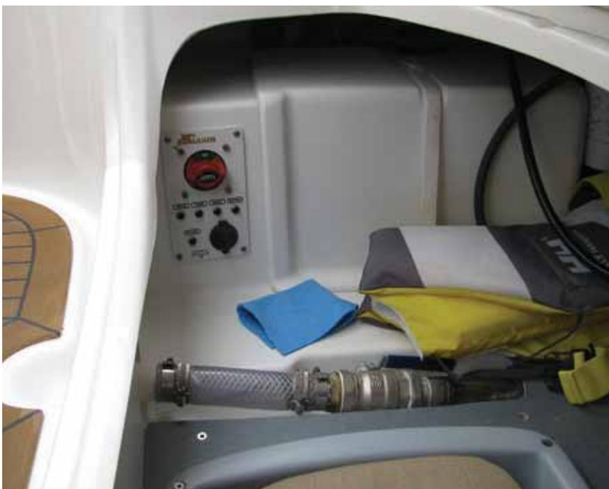
На финском катере Yatagin вся «электрика» скрыта под зашивками. В трюме доступен только щиток с главным выключателем и предохранителями основных групп
