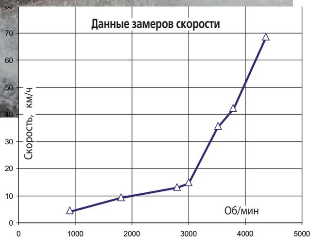
Кривая скорости от оборотов очень типична для водометных лодок. Рабочий диапазон начинается от 3000–3500 об/мин, когда движитель развивает достаточную тягу
