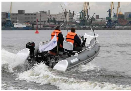
можно было дать полный газ. Небольшие «кочки» крутой нос пробивал насквозь, с более высоких лодка уверенно спрыгивала, не подвергая пассажиров избыточным нагрузкам. Значительная ширина, конечно, сказывалась: лодка немного подрыскивала на косых гребнях, но удержать ее на курсе было нетрудно.
