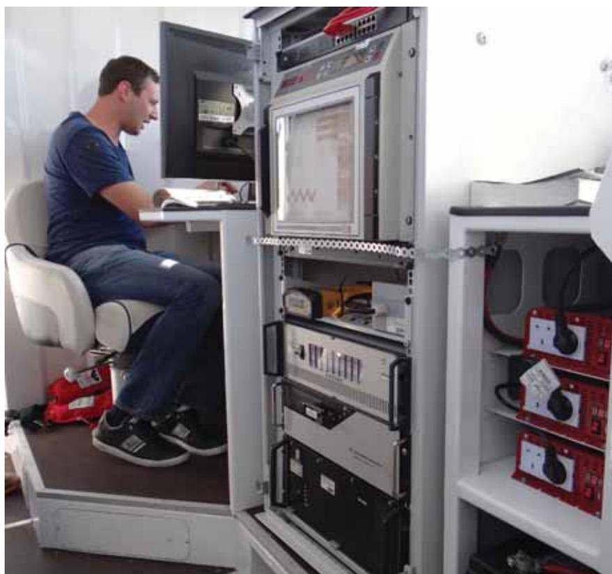
Оператор ведет площадную съемку поля рельефа дна, для дальнейшего составления контрольной карты глубин после проведения дноуглубительных работ. Ширина траления многолучевым эхолотом позволяет быстро закрыть площадь исследуемого участка
