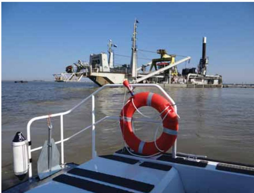
Кормовая площадка-кринолин очень удобна для работы с опускаемым исследовательским оборудованием и забортными устройствами (например: для взятия проб воды и грунта, стратифицированного замера температуры, прозрачности и солёности воды)
