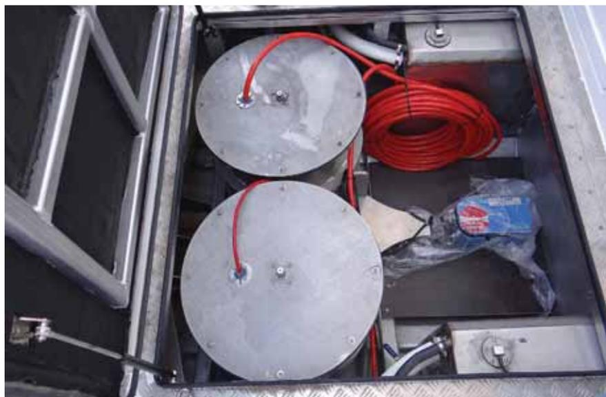
Шахты с опускаемыми излучателями эхолотов многолучевого и однолучевого
