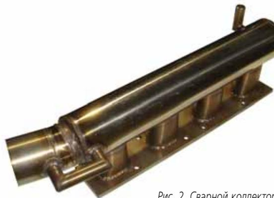
Рис. 2 Сварной коллектор
