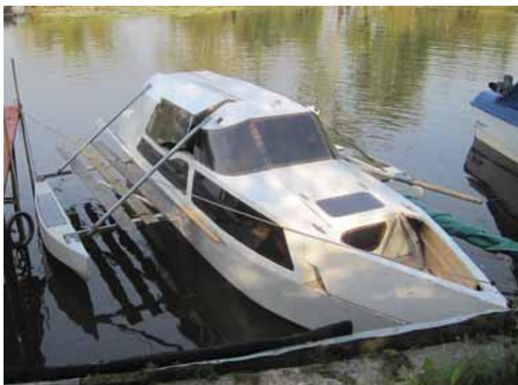
Судно состоит из 15 модулей (в максимальной комплектации). Возможна перестановка или удаление модулей. Аутригеры (поплавки) герметичны. Траверсы – труба 20×40. Застекление – поликарбонат 5 мм
