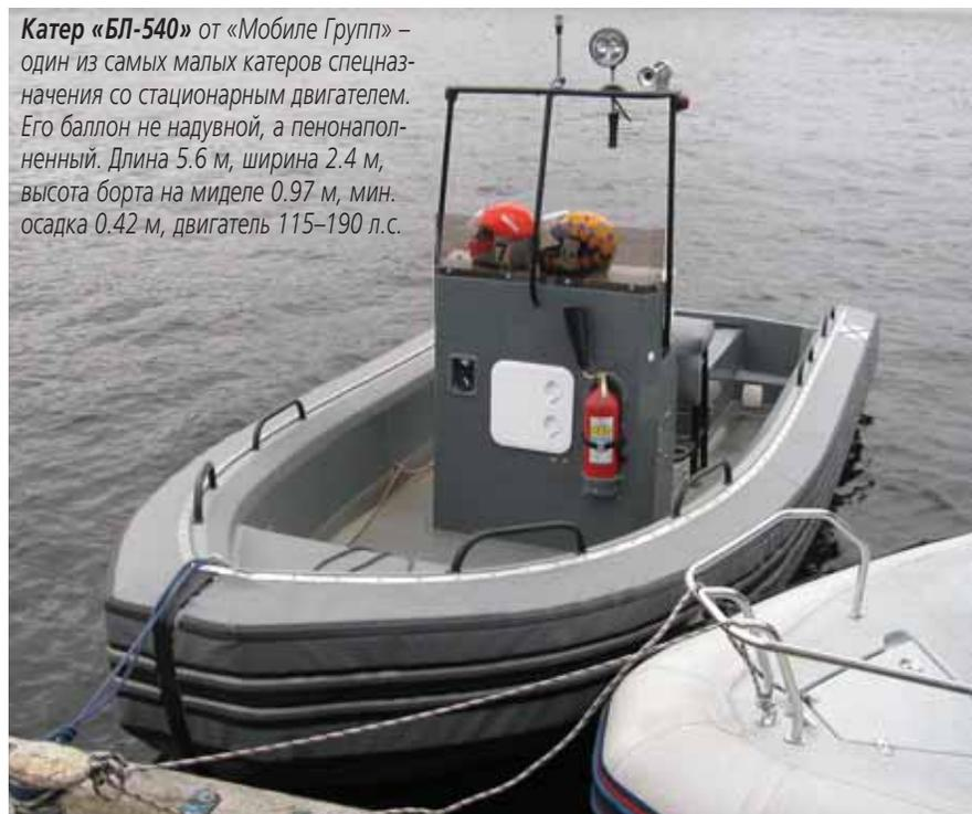
*Катер «БП-540» от «Мобиле Групп» – один из самых малых катеров спецназначения со стационарным двигателем. Его баллон не надувной, а пенонаполненный. Длина 5.6 м, ширина 2.4 м, высота борта на миделе 0.97 м, мин. осадка 0.42 м, двигатель 115–190 л. с.*
