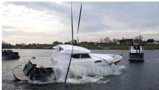
Видеоролик об испытаниях голландского катера неограниченного района плавания **Elling E4** на переворот оверкиль облетел специализированные интернет-ресурсы. Длина 14.95 м, ширина 4.25 м, осадка 1.2 м, двигатель Volvo Penta 200 л.с.
