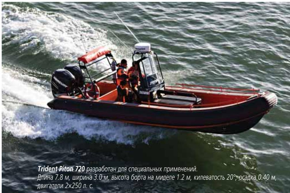
*Trident Piton 720 разработан для специальных применений. Длина 7.8 м, ширина 3.0 м, высота борта на миделе 1.2 м, килеватость 20°, осадка 0.40 м, двигатели 2x250 л. с.*
