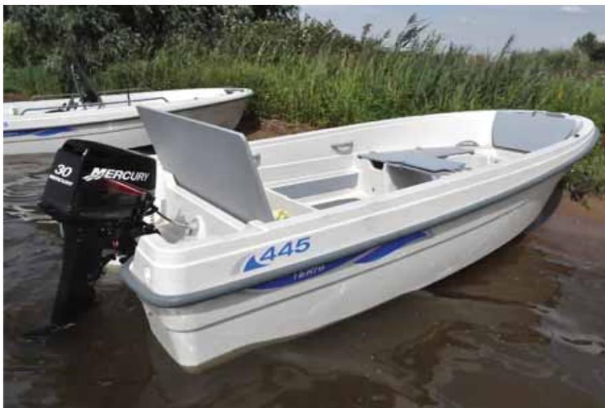
Третье преимущество данного корпуса – выход на берег. Лодка легко выходит и затягивается на сушу и, что самое главное, без проблем сталкивается обратно. Небольшая килеватость на транце не вгрызается в песок, даже в одиночку можно спокойно сталкивать корпус обратно в воду.
