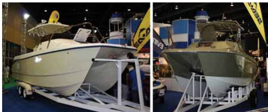
Рис. 2. 8-метровые катамараны проектов AT800 «Boomerang» и STC790 «Crocodile» на выставке. Хорошо видны типы обводов – симметричные (слева) и split hull . Обратите также внимание на конструкцию трейлеров – симметричный катамаран позиционируется направляющими на тоннеле и стоит на килях, что упрощает «заезд» на трейлер, split hull позиционируется и стоит на днище как обычный катер с V-образным днищем
