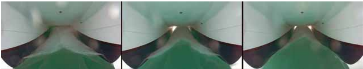
Рис. 4. Обтекание тоннеля симметричного катамарана проекта AT800W. Фото соответствуют относительным скоростям Fn_v = 2.5, 3.4 и 4.1 . Обратим внимание на просвет в тоннеле – у правильно спроектированного глиссирующего катамарана тоннель в кормовой части может замыкаться брызгами, но не должен использоваться для создания подъемной силы
