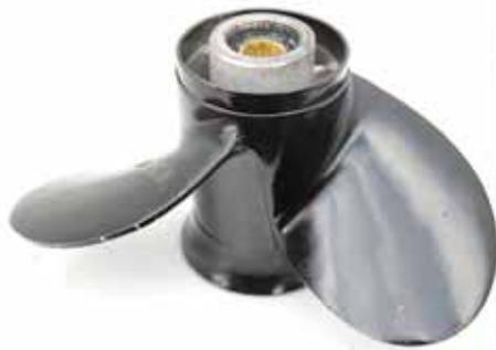
Комплектный винт шагом 9" изготовлен довольно грубо и был подвергнут «тюнингу»
