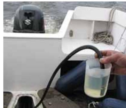
Расход измеряли методом мерной емкости
