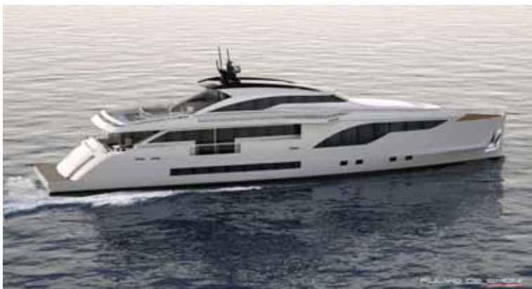
Wider 125: длина – 38,2 м, ширина – 7,93 м, осадка макс. – 2 м, водоизмещение – 215 т, энергетическая установка – дизель-электрическая 2×275 кВт, запас топлива – 30 000 л, запас воды – 12 000 л
