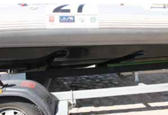
Сложная система воздушных каналов на поперечных реданах судна московской команды Elko
