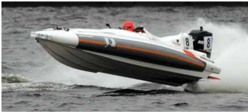
Лодка команды New Star лишена поперечных реданов, но использует схожий принцип снижения ударных нагрузок, встречая волну выступающим ниже уровня киля «клювом» в носовой части
