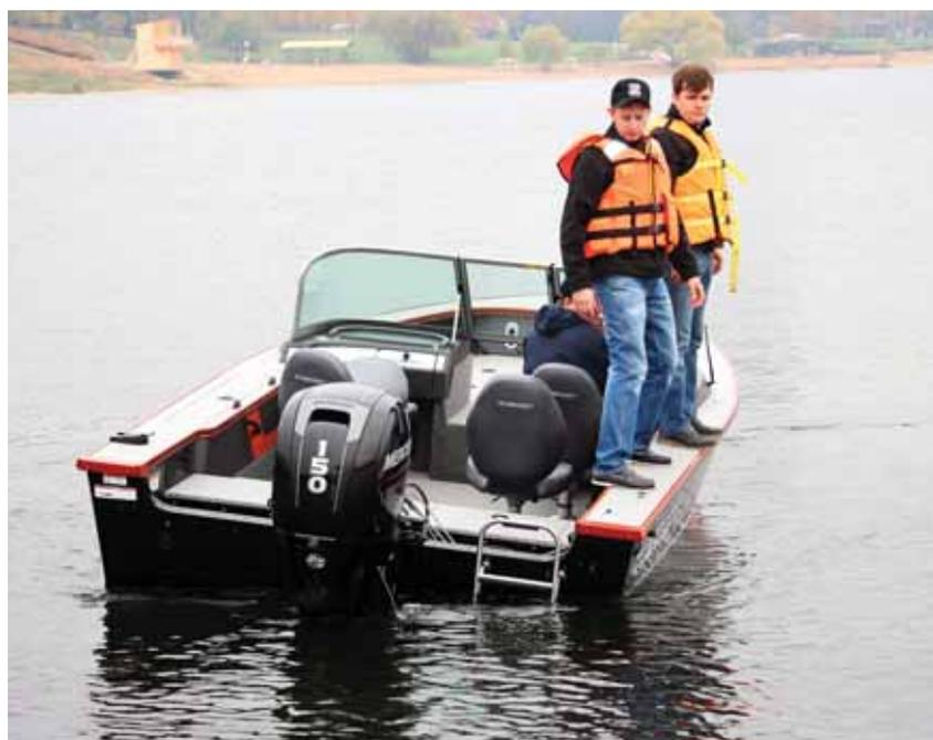
ными листами, образуя «сэндвич» толщиной 5 мм. Такая толщина и запенивание полостей корпуса обеспечивают очень высокую степень шумоизоляции и непотопляемость. Выраженный мощный киль придает корпусу жесткость, курсовую устойчивость и остроту управления. Гарантия на корпус для первого владельца – 20 лет.
