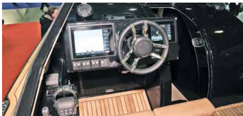
В стильном катере Velvette NGT 27 реализована полностью электронная система управления от Volvo Penta
