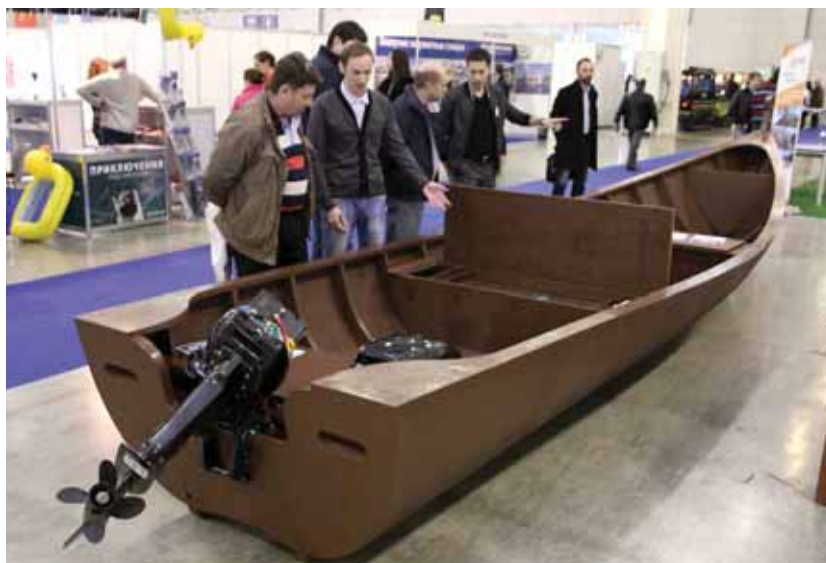
На стыке эпох: деревянная, почти традиционная лодка с высокотехнологичным электроприводом мощностью 20 л.с.
