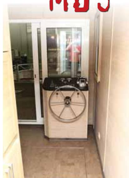
биной, гардеробом и огромной кроватью, откуда открывается замечательный вид по курсу, а через сдвижную стеклянную дверь можно выйти на носовую палубу. Рядом, по правому борту расположен внутренний пост управления. Обзор отсюда неважный, не сравнимый с тем, что предоставляет верхний рулевой мостик, но при нахмурившейся погоде вполне можно довести судно до родной гавани в тепле и сухости.
