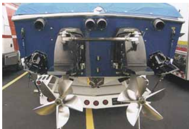
Рис. 15. Двигательный комплекс скоростного катера с угловыми ПОК и ЧПГВ
