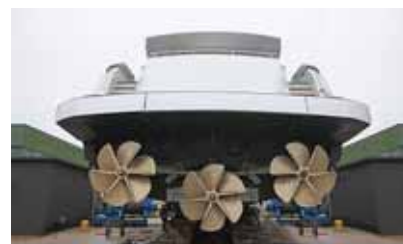
Рис. 13. ЧПГВ с приводами Арнесона на трехвальном катере
