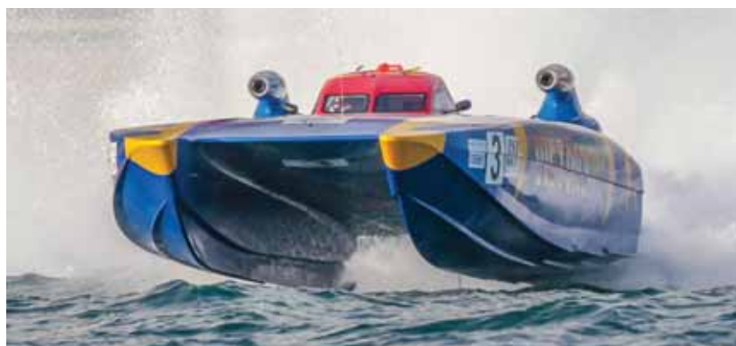
Рис. 6. Форма корпуса современных гоночных катамаранов с асимметричными обводами
