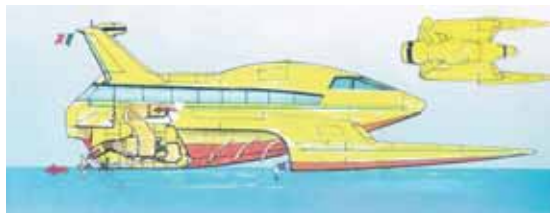
Рис. 10. Схема скоростного пассажирского тримарана
