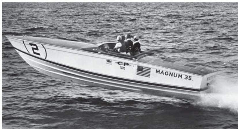
Рис. 1. Гоночный катер Magnum 35 с корпусом «глубокое V»
