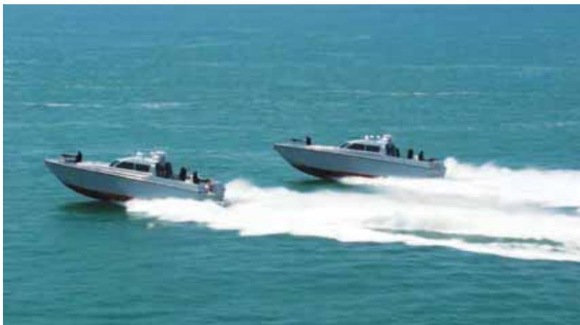
*Катер-перехватчик пр. SM16. Длина – 16 м, водоизмещение – 16.5 т, развивает скорость 52 уз в полном грузу. Водометы, бронирование надстройки, материал корпуса – композит / сэндвич. На момент написания статьи на воду спущено 45 таких судов, они стоят на вооружении ВМС Индии. Проект в 2013 г. получил титул «Значительное малое судно» RINA*
