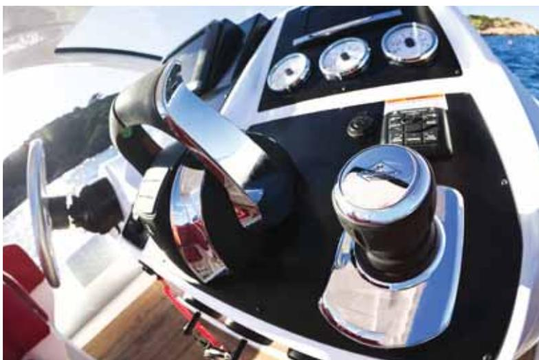
Система SmartCraft обеспечивает судоводителя непрерывно обновляемой информацией о мгновенном и среднем расходе топлива, дальности хода по запасу горючего, уровню топлива в баке, параметрах работы двигателя,
