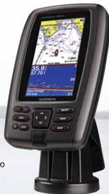
Прийти (именно так, по-морскому) на «поле битвы» с высокой точностью пользователю поможет GPS/ГЛОНАСС-модуль. Он обновляет данные о местоположении лодки с частотой 5 раз в секунду, что позволит отъявленному любителю рыбалки ставить точные метки интересных мест и отслеживать в реальном времени свои перемещения.
