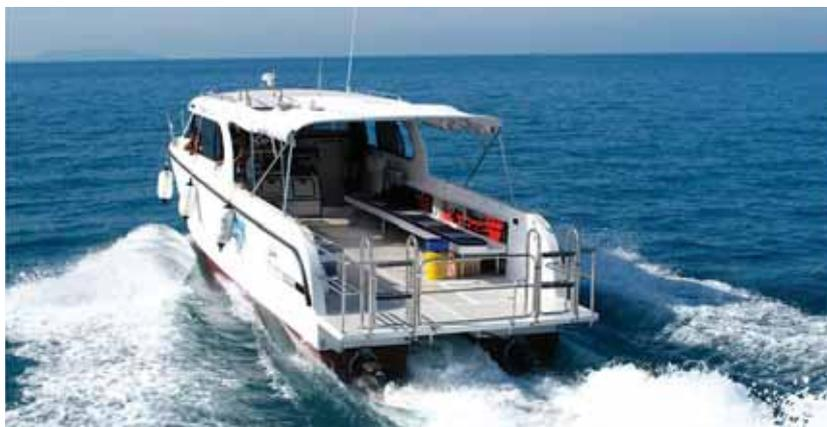
**Рис. 4.** 10-метровый катамаран проекта AT1000 в дайверской модификации – «морской пикап». Видны продольные банки для дайверов с полками для снаряжения сразу за ними
