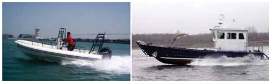
**Рис. 2.** 6.8-метровый катамаран-РИБ NS680 (Китай) с поперечными реданами и 11.5-метровый алюминиевый катамаран LC1150 с носовой аппарелью постройки «Охтинской судовой верфи» (Россия)
