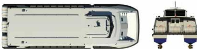
**Рис. 5.** Пассажирский катамаран из композитов проекта PM1800 – первое подобное судно, построенное в России компанией «Композитное Кораблестроение» на класс Морского регистра судоходства
