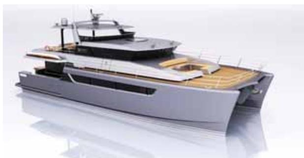
**Рис. 12.** Экспедиционный катамаран проекта Н80 – судно вписывается в верхний «волшебный габарит» малого судна и при длине 23,9 м за счет ширины предоставляет владельцу комфорт суперяхты. Помещения гостей расположены в уровне моста, с санузами на нижней палубе – в корпусах
