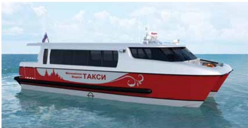
**Рис. 3.** Пассажирский катамаран проекта ASV1100. Длина – 11 м, ширина – 3,6 м, вместимость – 36 пасс., крейсерская скорость в зависимости от двигателя – до 30 уз
