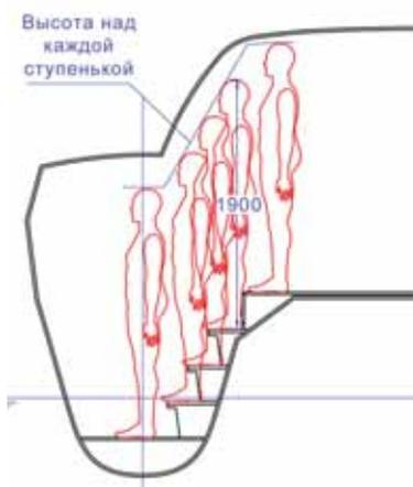
**Рис. 10.** Типичная ошибка при проектировании катамаранов – недостаточная высота над трапами. Особенно часто встречается на катамаранах с излишне «зализанной» рубкой; на них приходится сгибаться при спуске с моста в корпус. Как показывают результаты исследований, форма рубки оказывает незначительное влияние на аэродинамическое сопротивление, если, конечно, не идет речь об экстремальной конструкции гоночного парусного катамарана. Отсюда возможны рубки в стиле «ящик на палубе»
