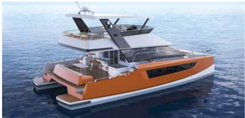
**Рис. 8.** В катамаране H48 применена концепция открытого пространства, визуально объединяющего кормовую палубу и салон через большой проем дверей салона. Комингс двери «спрятан» в рецесс моста. Койки расположены в корпусах
