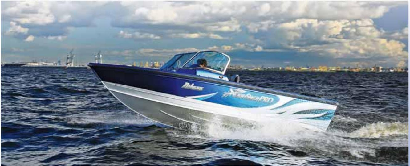
Лодка стала устойчивее на курсе, брызговые струи ушли назад, а прохождение волны осталось таким же плавным – благодаря в первую очередь 20-градусной килеватости в сочетании с хорошей энерговооруженностью, предоставленной 150-сильным четырехтактным Mercury.
