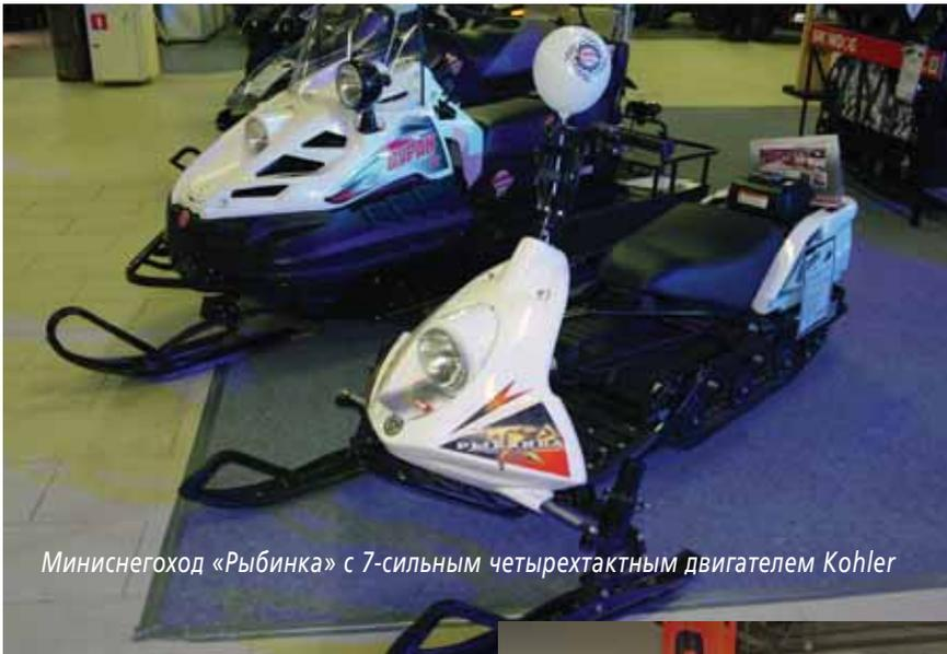
Миниснегоход «Рыбинка» с 7-сильным четырехтактным двигателем Kohler
