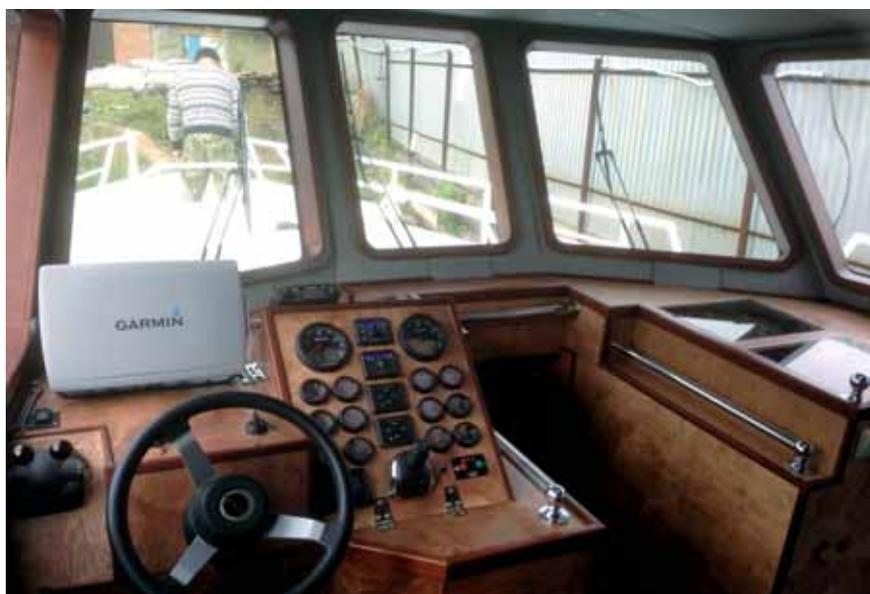
В 1992 г. в Иркутск пришли два 14-метровых алюминиевых водометных катера на газовой каверне типа «Сайгак» пр. 14081 (в них применялось наполнение воздушной каверны выхлопными газами двигателя, а не специальными нагнетателями). Разработчик – петербургское КБ «Редан», катера были построены на ССЗ «Кама» в Перми, оснащались дизелями М401 в 1100 л.с. завода «Звезда», аналогичными тем,
