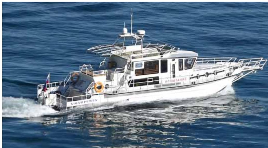
тами G4. Но в эксплуатацию судно было введено с более легкими винтами G3, а максимальная скорость снижена до 60 км/ч. Облегчение винтов необходимо, поскольку нагрузка может меняться значительно, плюс нужен запас мощности для движения по волне и при сильном ветре.
