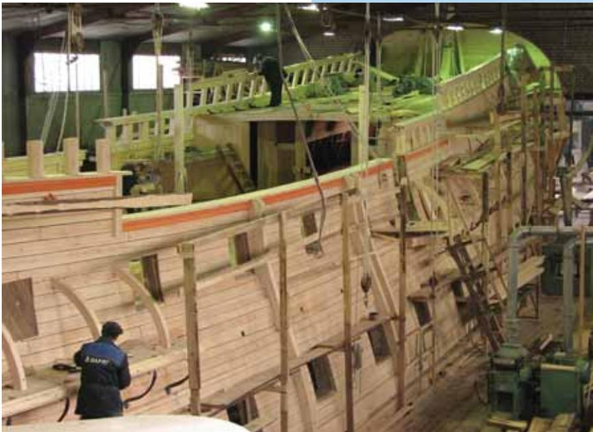
без мачт «Гото Предестинация» под ними не проходила. В связи с этим в процессе обсуждения родилась идея постройки корабля с металлической нижней частью в виде плоскодонного понтона и деревянной верхней, которая повторяла бы облик петровского корабля.
